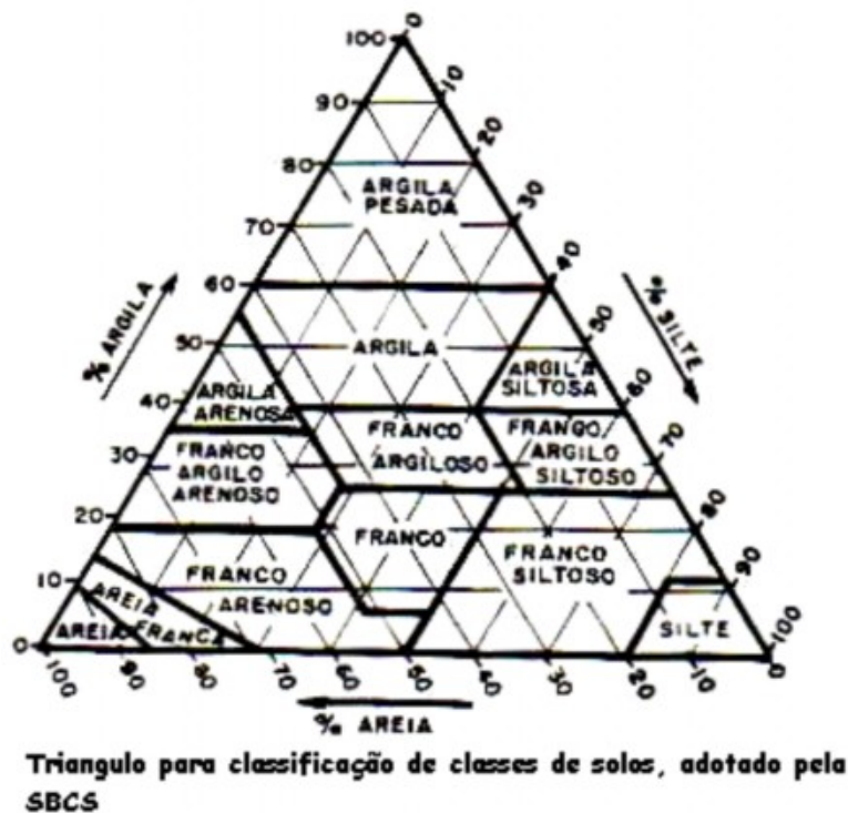
Figura 3.6.: Triângulo textural para classificação de solos segundo a proporção de areia, silte e argila.
