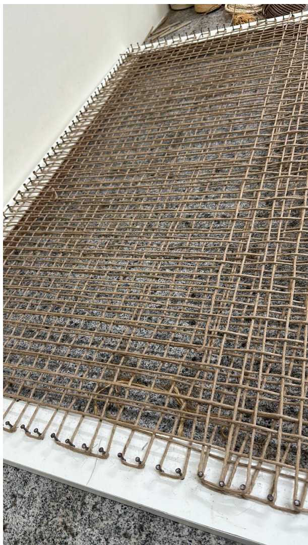
Figura 19.1.: Tear para confecção de biotêxteis — fibras vegetais sendo tramadas para produzir geotêxteis biodegradáveis com abertura e gramatura controladas.
