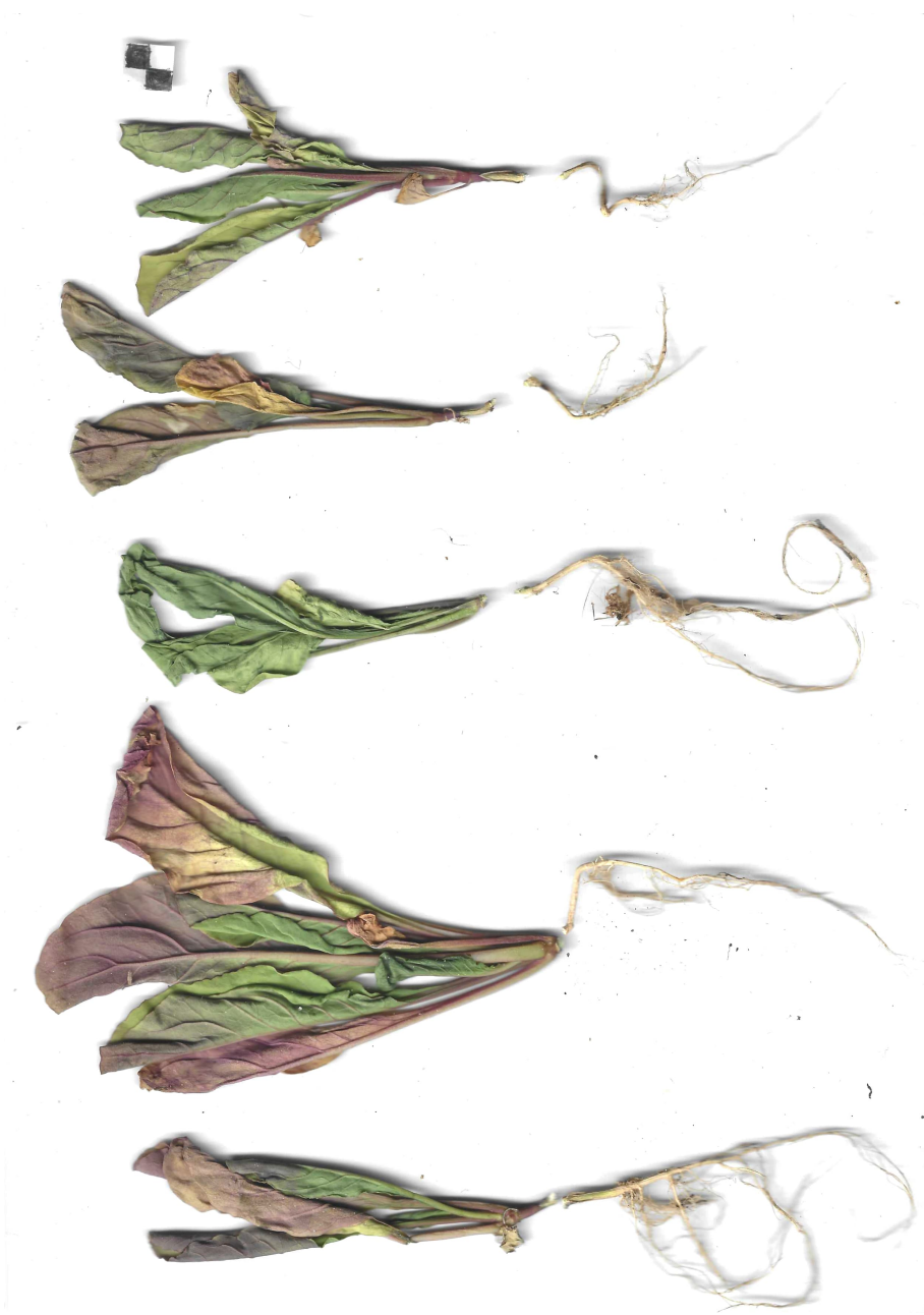
Figura 20.4.: Ensaio de alelopatia e germinação com Bio-SAP — avaliação do efeito do biopolímero sobre o crescimento de plântulas, demonstrando ausência de fitotoxicidade.
